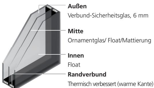
**3-fach-Verglasung =  $U_g$  0,6  $\text{W}/(\text{m}^2\text{K})$**
