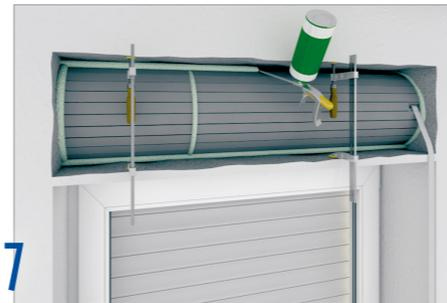
7. Dämmplatten mit Montageschaum am Anschlag und in den Stoßbereichen verkleben und abdichten.
